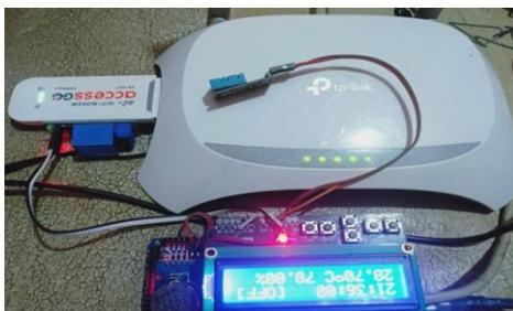
Gambar 7. Rangkaian Komponen yang di hubungkan ke Router
